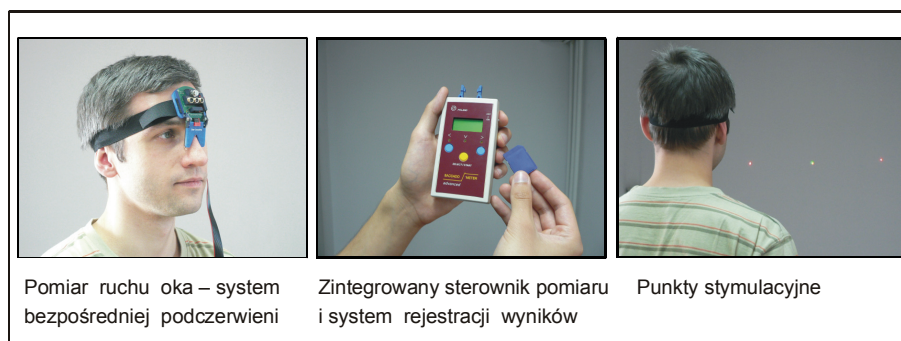
Ryc. 8. Oprzyrządowanie do pomiaru odruchu refleksji sakkadowej. Po lewej czujnik systemu umieszczony na głowie osoby badanej, zawierający także zintegrowany system pobudzenia w postaci trzech miniaturowych projektorów laserowych. W środku sterownik systemu kontrolujący pomiar i rejestrujący wyniki badania. Dodatkowo sygnał ruchu oka oraz stan pobudzenia mogą być zapisywane na karcie pamięci. Po prawej: punkty stymulacyjne są rzutowane na płaszczyznę projekcyjną przed osobą badaną. Umieszczenie projektorów pobudzeń na głowie badanej osoby pozwala na wyhamowanie odruchu oczno-przedmiotowego, redukując tym samym niekontrolowane zmiany pozycji oka (Miller N.R., 2004)
